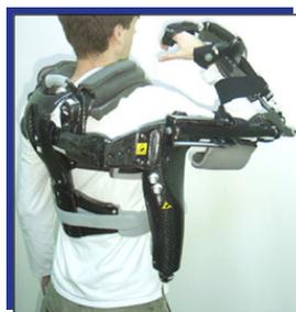
RUPERT: un dispositivo para terapia robótica repetitiva de las extremidades superiores.
