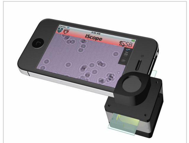
Un teléfono celular con un módulo especial puede procesar muestras de cuello uterino para identificar células cancerosas y precancerosas. Crédito: Ralph Weissleder y Hakho Lee/Hospital General de Massachusetts
