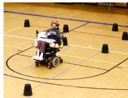
Un hombre guía su silla de ruedas alrededor de una pista de obstáculos utilizando el sistema de imán lingual y auricular.
