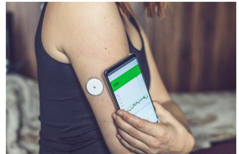
*Un monitor continuo de glucosa contiene enzimas que detectan la glucosa en el líquido entre las células. El smartphone del usuario recibe lecturas de glucosa del sensor las 24 horas del día.
